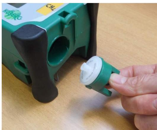
**Remplacez le filtre et remontez-le avec le couvercle du filtre en le tournant dans le sens horaire.**
