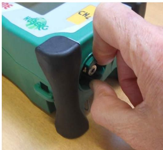
**Déverrouillez le couvercle du filtre en le tournant dans le sens inverse des aiguilles d'une montre**
